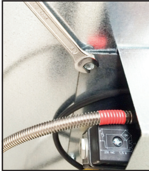
4 Schrauben in den Ecken abschrauben (Schlüssel 8)
